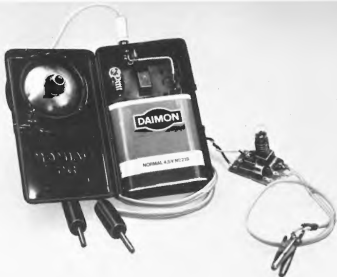
Foto 1. Indicatore di continuità: a sinistra la lampada tascabile e a destra il circuito elettronico di Fig. 3.3, da collocare in un involucro a piacimento
