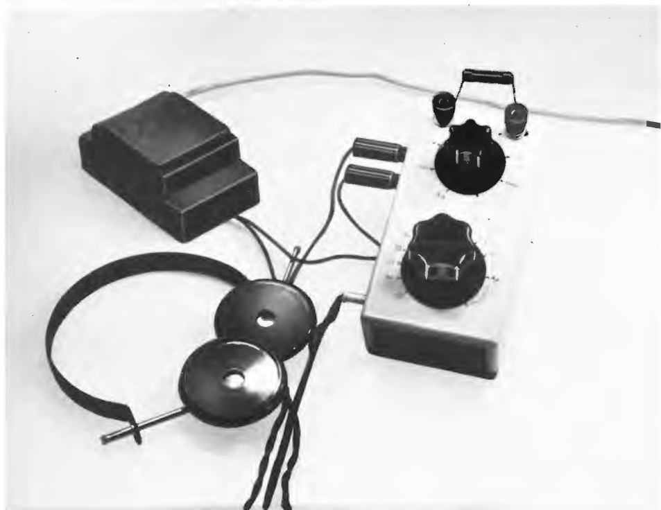
Foto 4. Ponte per la misura di resistenze, secondo la Fig. 9.4, con una cuffia come indicatore.
